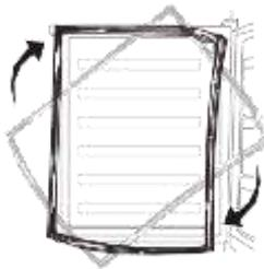
27. Befestigen Sie die Gefrierschranktür an dem unteren Türscharnier. Setzen Sie dazu den Scharnierbolzen des unteren Türscharniers vorsichtig in die untere Scharnieröffnung der Gefrierschranktür ein. Halten Sie die Tür in Position; s. Abb. unten.
