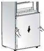
28. Richten Sie das mittlere Türscharnier (**J**) ordnungsgemäß an den vorbereiteten Löchern auf der linken Seite des Gerätes aus; s. Abb. unten (möglicherweise müssen Sie das mittlere Scharnier um  $180^{\circ}$  drehen, um es an den vorbereiteten Löchern auszurichten -modellabhängig-). Setzen Sie dabei den Scharnierbolzen des mittleren Türscharniers vorsichtig in die obere Scharnieröffnung der Gefrierschranktür ein und schrauben Sie dann das Scharnier fest.
