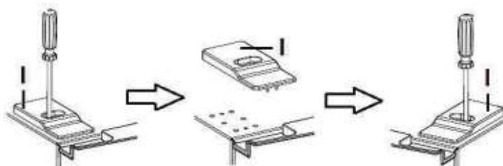
13. Heben Sie die Kühlschrantür an und entnehmen Sie sie vorsichtig; s. Abb. unten. Legen Sie die Kühlschrantür mit der Außenverkleidung nach oben auf eine gerade Oberfläche.
