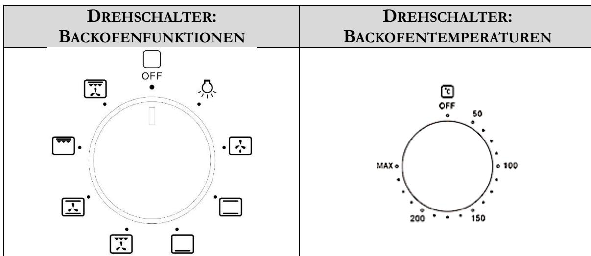
**HINWEIS!** Drehen Sie den Drehschalter zur Auswahl der Backofentemperaturen nur im Uhrzeigersinn auf die gewünschte Temperatur. Danach können Sie den Schalter zurück auf die Ausgangsposition drehen. Ansonsten können Sie die Drehschalter beschädigen.
