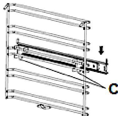
6. Bevor Sie die Gerätetür schließen, vergewissern Sie sich, dass alle Teleskopauszüge vollständig eingeschoben sind.
