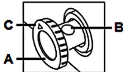
11. Drücken Sie die Wasserablassschraube (A) wieder vorsichtig und ordnungsgemäß in das Gerät hinein (s. Abb. unten, schwarzer Pfeil).
