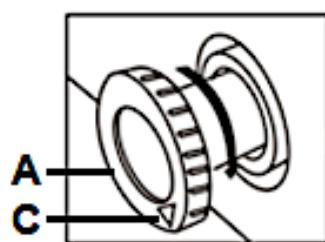
8. Lassen Sie das Tauwasser mittels der Wasserablassöffnung ablaufen.
