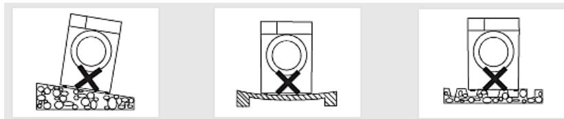
12. Falls Sie das Gerät auf einem Holzfußboden installieren, **müssen** Sie es zusätzlich auf eine **mindestens** 3,00 cm dicke Sperrholzplatte (60,00\*60,00 cm) stellen, um das Gewicht des Gerätes zu verteilen. Befestigen und sichern Sie die Sperrholzplatte ordnungsgemäß auf dem Holzfußboden.
