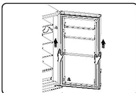
8. Entnehmen Sie den Türanschlagblock (4) und die Türlagerbuchse (5) von der linken Türseite des Gerätes und installieren Sie sie wieder auf der rechten Türseite (s. Abb. unten.).
