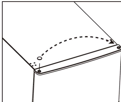
8. Heben Sie die Gerätetür an und entnehmen Sie sie vorsichtig; s. Abb. unten. Legen Sie die Gerätetür mit der Außenverkleidung nach oben auf eine glatte Oberfläche, damit sie nicht beschädigt wird.
