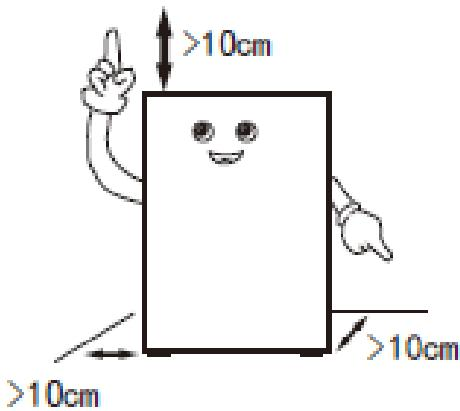
Um eine optimale Effizienz des Gerätes zu ermöglichen, empfiehlt der Hersteller folgende Mindestabstände.
