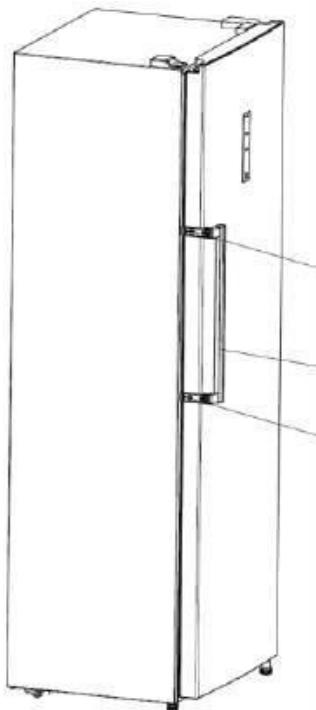
1. Montieren Sie die Bolzenabdeckungen auf die Bolzen.
