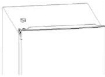
11. Bringen Sie die mitgelieferte obere linke Scharnierabdeckung am Schrank an, nachdem Sie den zylindrischen Türschalter installiert haben, und ziehen Sie die Schraube fest.
