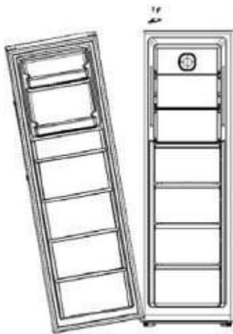
10. Öffnen Sie den Lochstopfen der Türabdeckung, entfernen Sie die Klemme des Kabelbaums an der Tür und schließen Sie die Kabel im Schrank nacheinander an, und schließen Sie dann den Lochstopfen.
