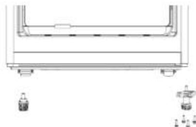
5. Die Füße (2) abschrauben und dann die Mutter (3) abschrauben. Die Scharnierwelle (5) aus dem rechten Loch (4) nehmen und in das linke Loch einsetzen. Ziehen Sie die Mutter und dann die Füße fest.
