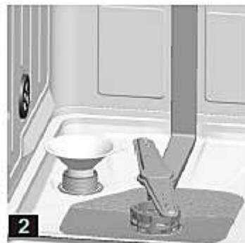
1. Entfernen Sie den unteren Geschirrkorb und den Deckel des Wasserenthärter-Behälters.
