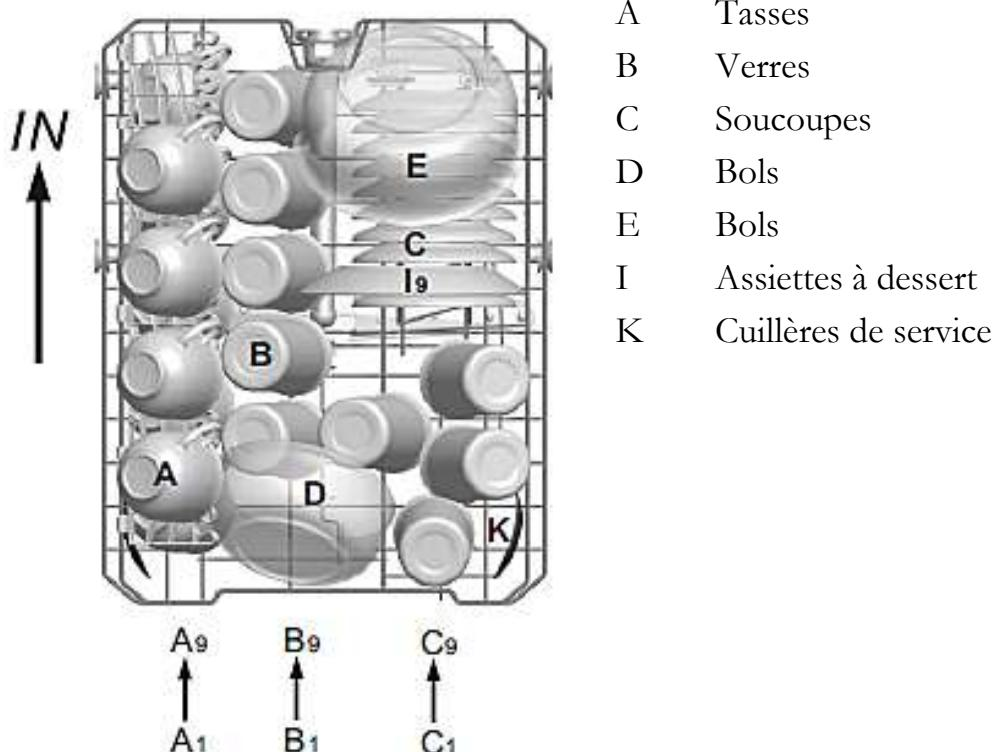
Vous pouvez régler la position du panier supérieur pour créer plus d'espace pour des objets volumineux, soit dans le panier inférieur ou le supérieur. Vous pouvez régler le panier supérieur en plaçant un ensemble de roues données dans le rail. Rangez des objets longs sur l'étagère pour ne pas entraver les bras de lavage rotatifs. Vous pouvez rabattre l'étagère si nécessaire.
