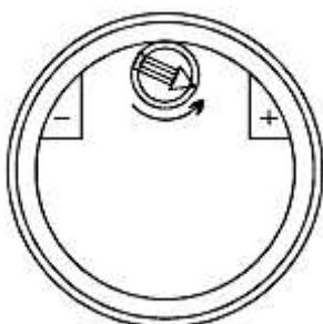
1. Schrauben Sie die Kappe des Wasserenthärter-Behälters ab.
